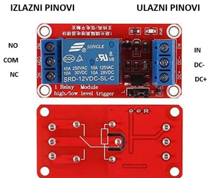
Slika 64 Ulazni i izlazni pinovi za klasični Arduino relej
